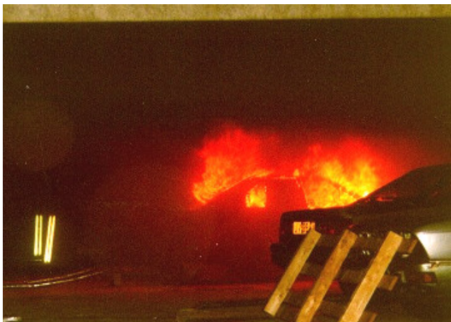
Abb. 1 Kontrollierte Rauchabfuhr für eine unbeeinträchtigte Sicht auf den Brandherd
