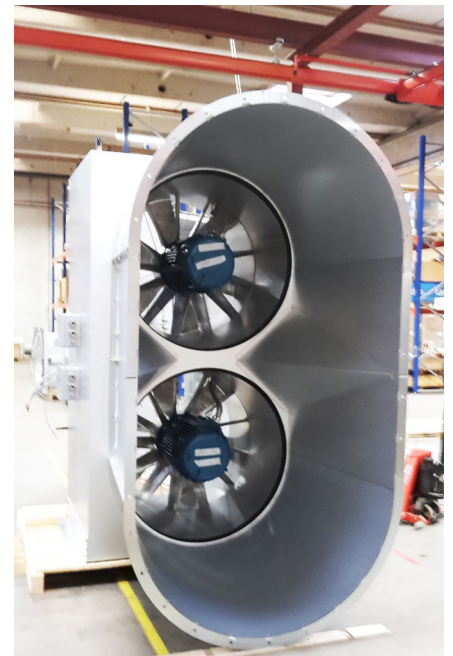
Montage der Fan Arrays im Werk
