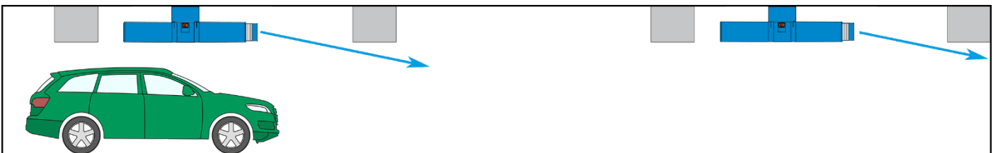
ABBILDUNG 6B: ANORDNUNG JET-VENTILATOREN ZWISCHEN UNTERZÜGEN
