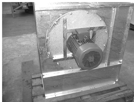
Figuur 1. Motor gemonteerd tegen de zijplaat
