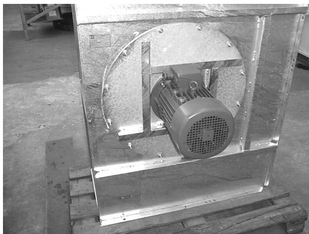
Abb. 1. Motor direkt auf der Motordeckelplatte montiert
